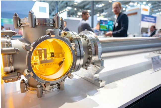
Bild 9: Im Fraunhofer Cluster of Excellence Advanced Photon Sources - CAPS werden Hochleistungs-UKP-Laser für Industrie und Forschung entwickelt. Im Bild: Multipass-Zelle für die Nachkompression bei 2 \mu\text{m} Wellenlänge. © Fraunhofer / Markus Jürgens.
